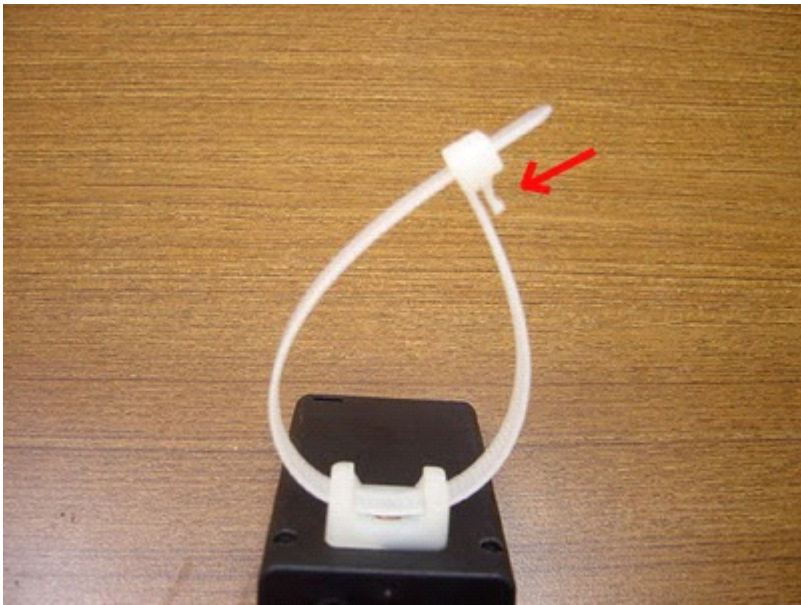
红色箭头所指的地方, 凸杆压下后, 就可以松开束线带了
